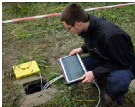
Mesure de la qualité et de la température de l'eau souterraine dans un forage (Source : HGE, [http://www.facsu.ulg.ac.be/cms/c\\_681446/en/hydrogeology-and-environment-geology](http://www.facsu.ulg.ac.be/cms/c_681446/en/hydrogeology-and-environment-geology))
