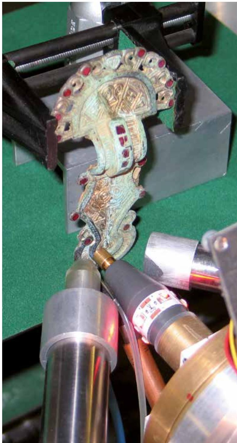
Faisceau de particules envoyé sur un bijou mérovingien. Deux détecteurs de rayon X captent le rayonnement émis par les atomes excités de l'objet pour en déterminer sa composition chimique.
