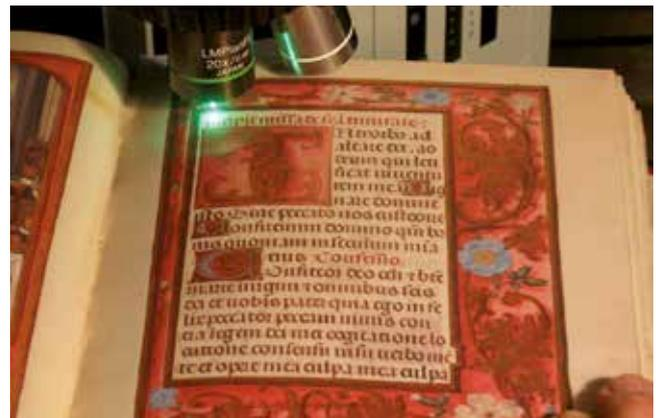
Analyse d'une enluminure par Spectrométrie Raman afin de déterminer la nature des pigments.
