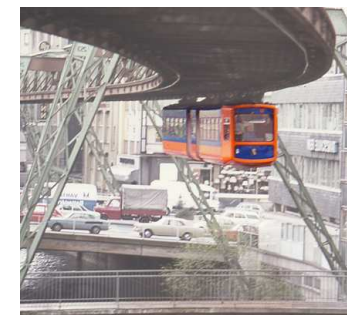
Le métro suspendu au-dessus de la rivière WUPPER existe depuis 1901 et ses voitures viennent d'être modernisées
